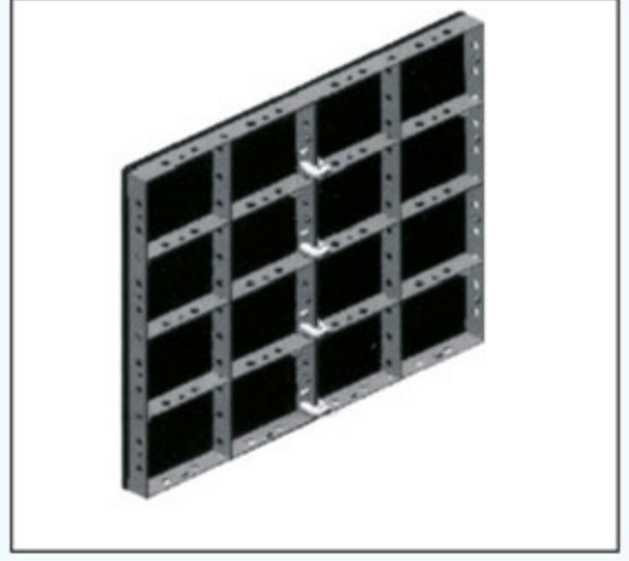
2. Panolar, seri deliklerden, pano kilidi bağlantı elemanları ile birleştirilir.
