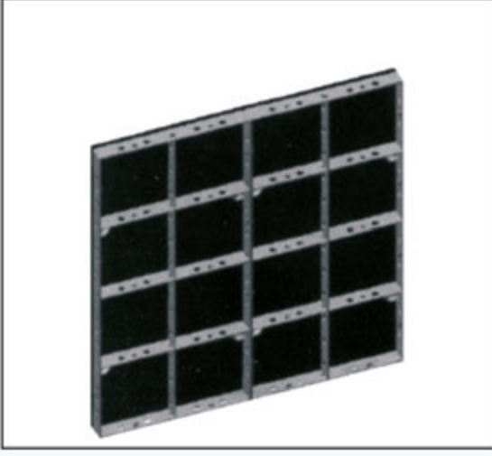
1. BERKA Modüler Kalıp Panoları yanyana getirilir. BERKA Modular Panels are arranged together
